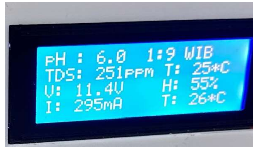
Gambar 9. Hasil pembacaan sensor DHT 11 dan INA219
